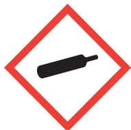
Ces produits sont des gaz sous pression contenus dans un récipient. Certains peuvent exploser sous l'effet de la chaleur : il s'agit des gaz comprimés, des gaz liquéfiés et des gaz dissous. Les gaz liquéfiés réfrigérés peuvent, quant à eux, être responsables de brûlures ou de blessures liées au froid appelées brûlures et blessures cryogéniques.
