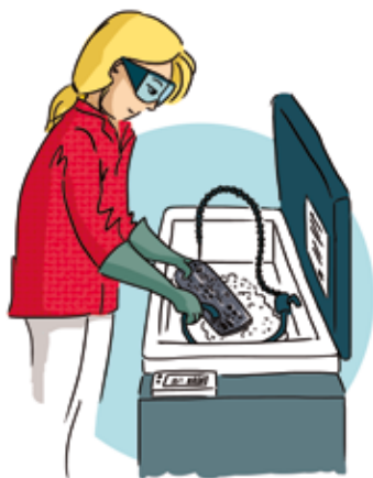
Agir sur le danger : exemple Remplacer le trichloréthylène par des produits lessiviels ou par une fontaine de biodégradation dans les opérations de dégraissage des pièces métalliques.
